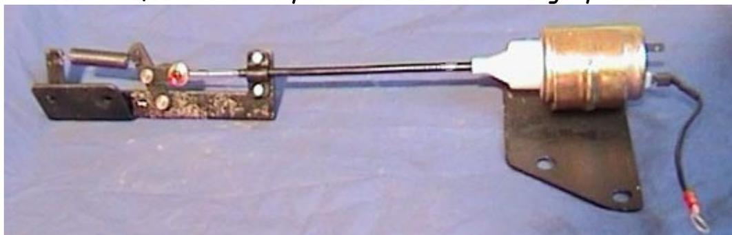
Электромеханическая часть состоит из соленоида заслонки (поз.7 рис.3), прикрепленного к основанию (поз.8 рис.3), из которого выходит тросик управления положением заслонки (поз.9. рис.3). Один из выводов соленоида подключается при помощи черного провода (с12, рис.3) к корпусу генератора (или основания). Вторым выводом (с9 рис. 3) при монтаже соединяется с проводом управления (см. Таблицу №1 и с9 на рис.1).
