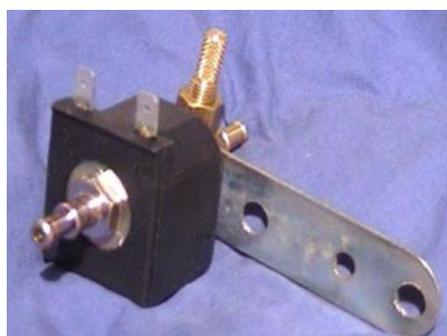
*Рис.5. Клапан бензиновый электро-магнитный*
