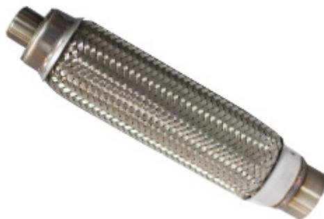
Сильфон с адаптером д. 38 и переходником предназначен для установки на генераторы мощностью до 15 кВт и с наружным диаметром выхлопной трубы 38 мм. Является частью системы отвода выхлопной системы. Изготовлен из стали марки AISI 304.
