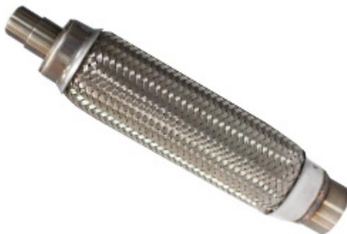
Сильфон с адаптером д. 32 и переходником предназначен для установки на генераторы мощностью до 15 кВт и с наружным диаметром выхлопной трубы 32 мм. Является частью системы отвода выхлопной системы. Изготовлен из стали марки AISI 304.
