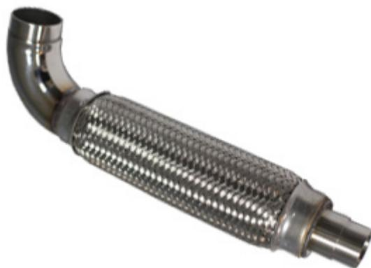
Сильфон с адаптером д. 22 и поворотной арматурой предназначен для установки на генераторы мощностью не более 6 кВт и с наружным диаметром выхлопной трубы 22 мм. Является частью системы отвода выхлопной системы. Изготовлен из стали марки AISI 304.
