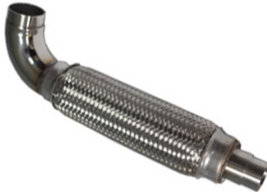
Сильфон с адаптером д. 32 и поворотной арматурой предназначен для установки на генераторы мощностью до 15 кВт и с наружным диаметром выхлопной трубы 28 мм. Является частью системы отвода выхлопной системы. Изготовлен из стали марки AISI 304.
