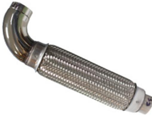
Сильфон с адаптером д. 38 и поворотной арматурой предназначен для установки на генераторы мощностью до 15 кВт и с наружным диаметром выхлопной трубы 38 мм. Является частью системы отвода выхлопной системы. Изготовлен из стали марки AISI 304.
