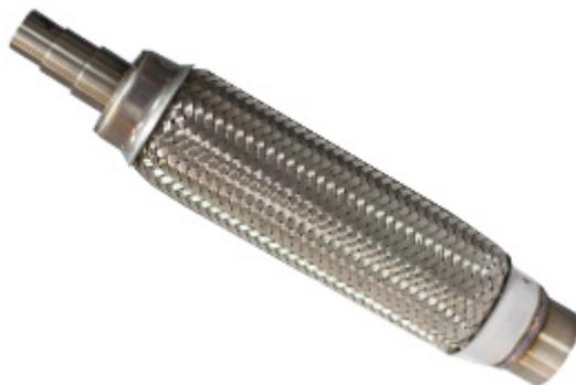
Сильфон с адаптером д. 22 и переходником предназначен для установки на генераторы мощностью не более 6 кВт и с наружным диаметром выхлопной трубы 22 мм. Является частью системы отвода выхлопной системы. Изготовлен из стали марки AISI 304.
