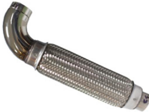
Сильфон с адаптером д. 44 и поворотной арматурой предназначен для установки на дизельные генераторы мощностью до 20 кВт и с наружным диаметром выхлопной трубы 44 мм. Является частью системы отвода выхлопной системы. Изготовлен из стали марки AISI 304.
