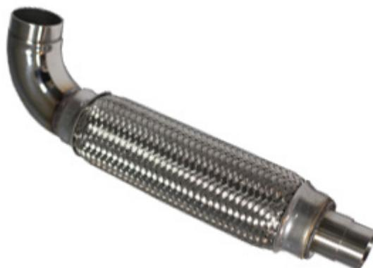
Сильфон с адаптером д. 25 и поворотной арматурой предназначен для установки на генераторы мощностью не более 6 кВт и с наружным диаметром выхлопной трубы 25 мм. Является частью системы отвода выхлопной системы. Изготовлен из стали марки AISI 304.
