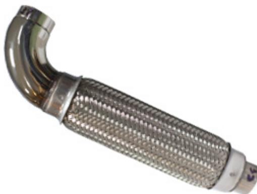
Сильфон с адаптером д. 35 и поворотной арматурой предназначен для установки на генераторы мощностью до 15 кВт и с наружным диаметром выхлопной трубы 35 мм. Является частью системы отвода выхлопной системы. Изготовлен из стали марки AISI 304.
