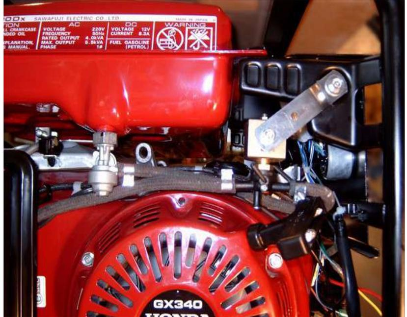
Рис. 2. Крепление бензоплапана на генераторных станциях HONDA и ELEMАX.
