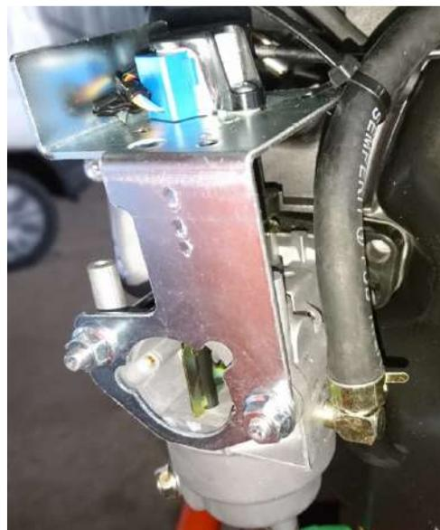
5. Снимите топливный шланг с карбюратора.
