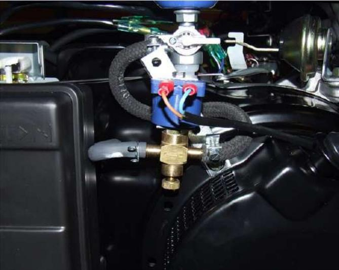
Рис.3. Крепление бензинового клапана на генераторной станции YAMAHA EF6600E.
