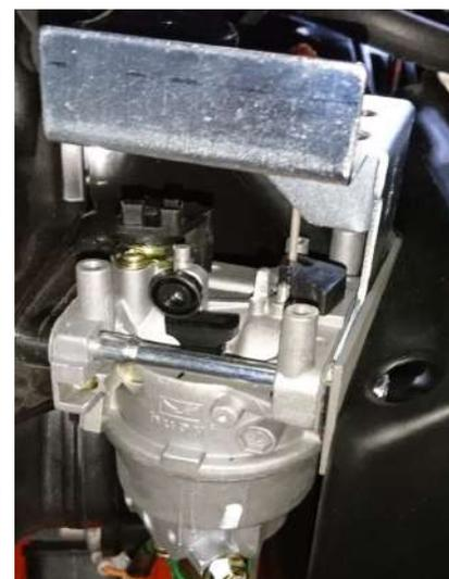
10. Примерьте заднюю крышку корпуса воздушного фильтра и, если ни чего не мешает, подключите провода питания воздушной заслонки и соберите воздушный фильтр. НЕ ЗАБУДЬТЕ установить осевую втулку дроссельной заслонки.
