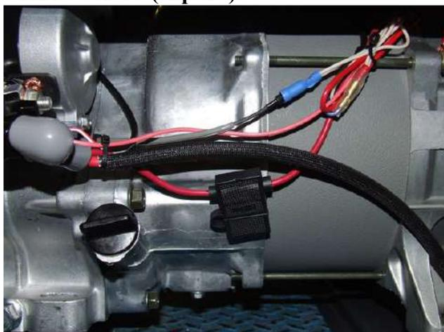
Рис.30 и рис.31. Примеры оформления жгута после подключения на ГС серии EF5200E и EF6600E фирмы Yamaha.
