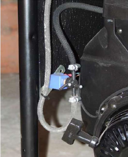
Рис. 1. Пример крепления бензоплапана на ГС SH10000 и SH15000 SDMO.
