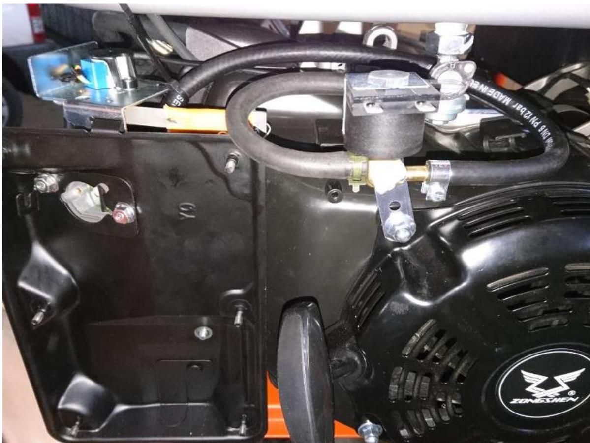
7. Приложите заднюю крышку корпуса воздушного фильтра, чтобы проверить, не задевает ли она шланги.
